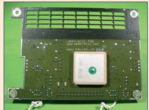
Die Oberseite der Empfängerplatine enthält nur die Patchantenne des GPS-Empfängers
