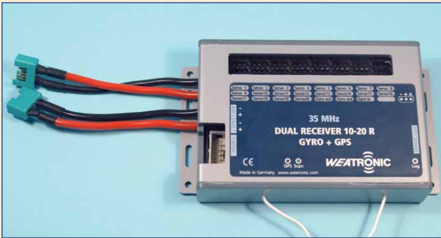
Weatronics derzeitiges Paradies, der Dual Receiver 10-20 R Gyro + GPS. Er enthält den Doppelpfänger, Akku-Umschalter, Gyro und GPS-Empfänger. Für die Akkus sind zwei Multiplex-Hochstromstecker schon fertig montiert
