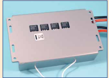
Auf der Unterseite des Dual-Receivers genießen die Spannungs-Stabilisatoren einen Blick ins Freie. Das ist der Kühlung zuträglich
