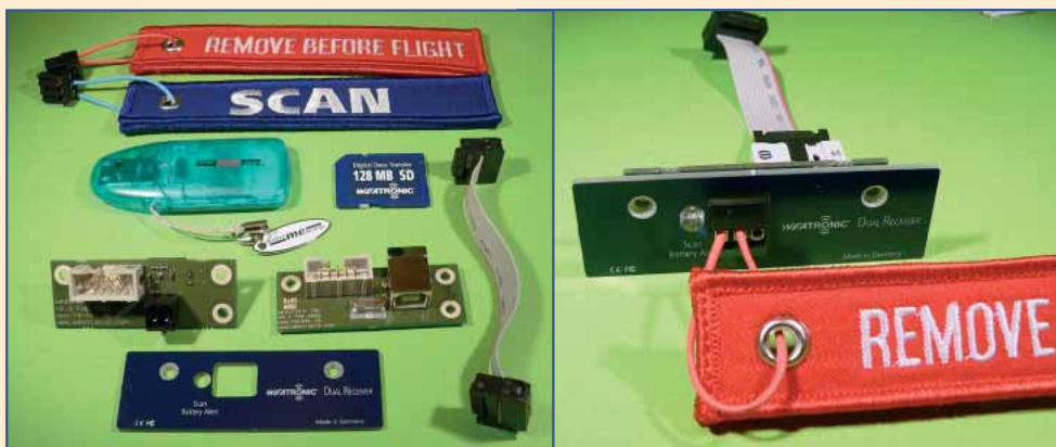
Der Dual-Receiver kommt mit reichlich Zubehör. Neben den beiden Steckern für das Ein/Ausschalten bzw. den Scan-Vorgang lagen noch das Schaltpanel und USB-Interface mit im Karton. Der Kartenleser und die SD-RAM-Karte können ebenfalls über Weatronic bezogen werden
