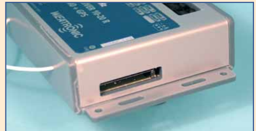
Der Steckplatz für die Speicherkarte nimmt eine SD/MMC-Karte auf. Je nach eingesteckter Speicherkapazität können stundenlang Flugdaten aufgezeichnet werden
