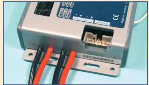
Hier findet das zehnrührige Flachbandkabel Anschluss. Es verbindet den Dual-Empfänger mit dem Schaltpanel und gegebenenfalls auch der USB-Schnittstelle
