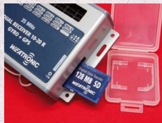
Auf der mitgelieferten SD-Karte können die Daten eines ausgedehnten Flugtags aufgezeichnet werden
