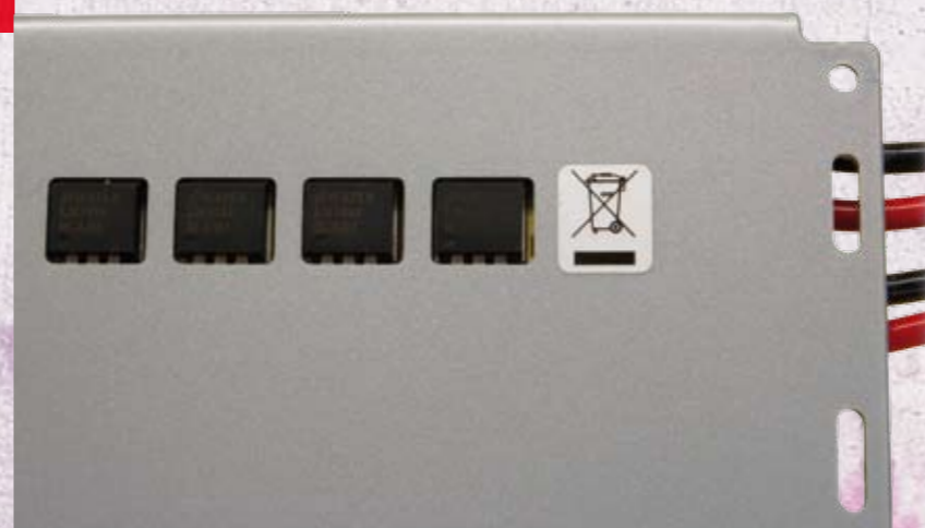
Nicht für die Mülltonne: die vier Spannungsregler vom Typ LM1084
