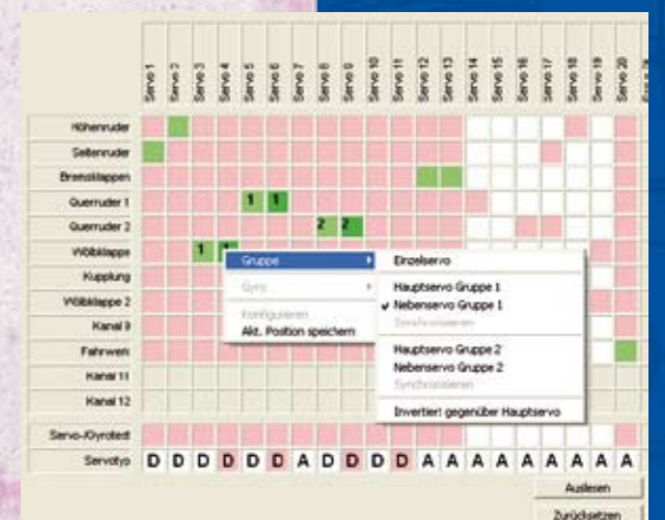
Jeweils zwei Querruder- und Wölbklappenservos bilden eine Gruppe
