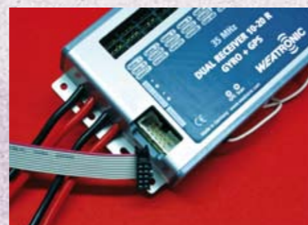
Der Interface-/Stellbordanschluss ist leicht erreichbar und trotzdem geschützt
